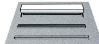
Die Führungsschienen auseinandernehmen. Dafür das Deckprofil ab- und die Laufschiene herausnehmen.
